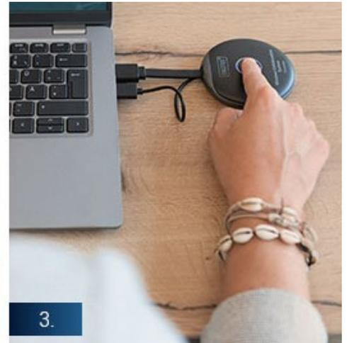
3. Drücken Sie anschließend die Verbindungstaste am Sender, um mit dem Übertragen Ihrer Bildschirm Inhalte loszulegen.
