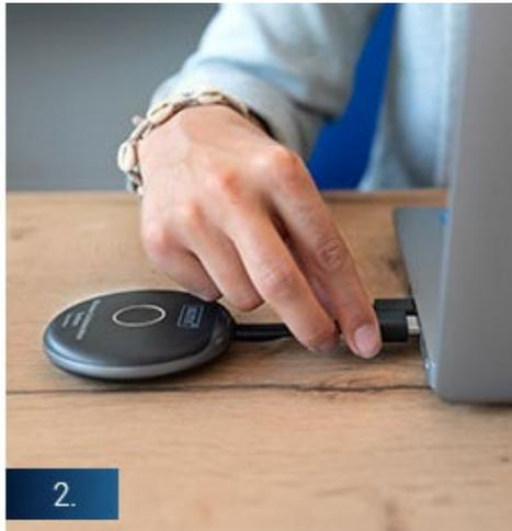
2. Verbinden Sie den Sender mit dem USB- und HDMI-Anschluss Ihres PCs. Sender und Empfänger bauen automatisch eine Verbindung auf.
